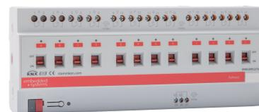
本开关执行器用于开关1路到12路独立电气交流负载或三相负载,每个控制接点输出的最大负载电流可选为10/16/20A，每路均可手动开启或关闭和带电流检测功(注意2路不带电流检测和手动开关功能)，开关状态外部可见。
