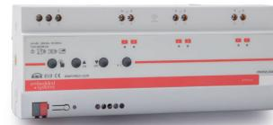
调光执行器采用先进冷MOS功率管，通过后沿切角实现负载功率控制，电磁污染小、效率高、满负载带载温升低于50度，适用于独立电气交流阻性和容性负载。自适应50Hz/60Hz电网频率。每个控制回路输出最大负载为3A/6A。调光执行器每路均可手动开启或增减调节，其状态通过指示灯可见。所有通道自带短路保护、过载检测、温度监测与过热报警自动停机功能。
