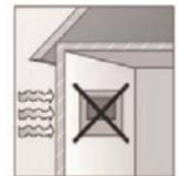
空气质量监测屏不得暴露于与液体直接接触的区域。
