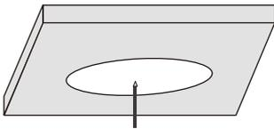
01.先用铅笔画一个圆孔，再用开孔工具开孔。
