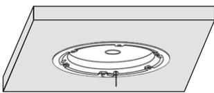
03.用十字螺丝刀，对音箱上的四枚螺丝进行固定。
