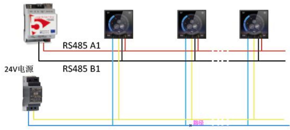
IMAGE三合一温控器与八键面板及空气质量监测面板连接示意图
